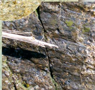
Stries (parallèles à la brindille) laissées sur un plan de faille du granite
